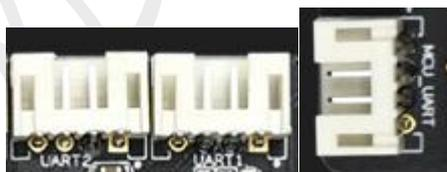
板卡引出了两组普通 UART 串口，可支持市面上通用的 UART 串口设备。
