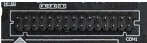
通用的 LVDS 接口定义，支持单/双，6/8/10 位 1080P LVDS 屏。屏电压可以通过跳线帽进行选择，可选择支持 3.3V/5V/12V 屏电源供电。
